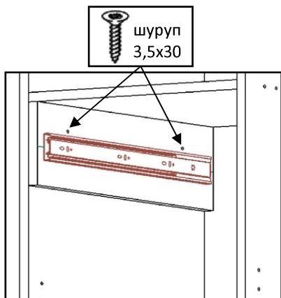
Подвести деталь 1 до задней стенки шкафа и полки шкафа, как на схеме, закрепить шурупами 3,5x30 к боковине или стойке шкафа.
