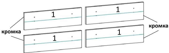
На детали 1 начертить линию по отверстиям 3 мм как показано на схеме.
