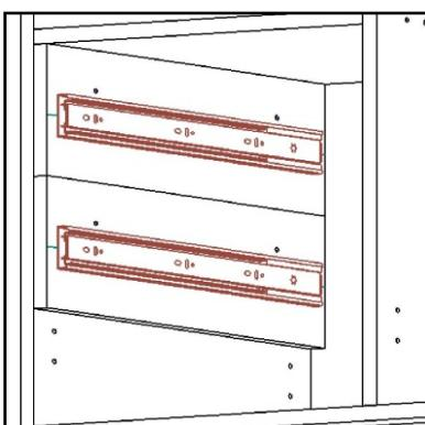
Аналогично установить вторую деталь 1, и две детали с противоположной стороны.
