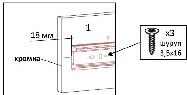
От стороны с кромкой отступить 18 мм до направляющей, закрутить шурупы в отверстия направляющей по линии на детали 1.
